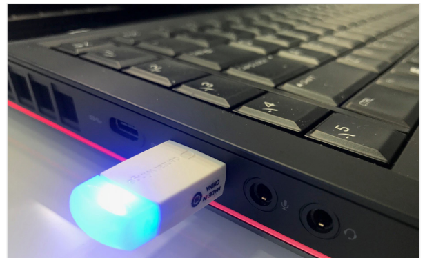
Prawidłowo działający klucz sprzętowy (niebieska migająca dioda LED)
