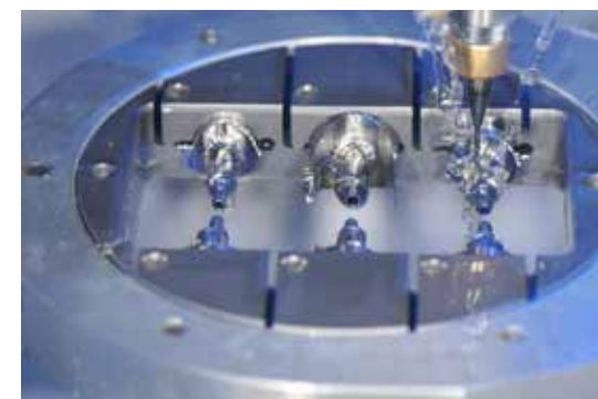
Frezarka CNC wycina jednocześnie sześć łączników
